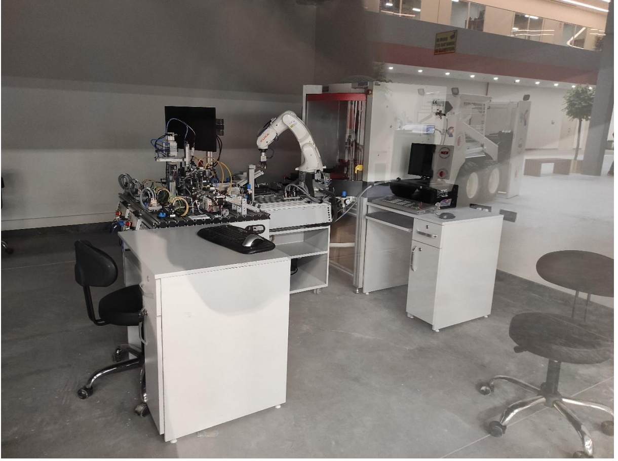
Endüstriyel kontrol eğitimi için kullanılan robot kol, imalat ve üretim hattına sahip eğitim seti
