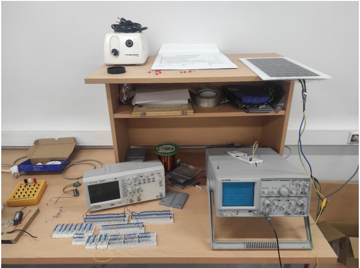
PV panelin elektrik üretimini göstermek için kullanılan deney düzeneği
